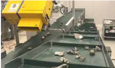
Robotdalen tar fram en robotprototyp för skrotsortering i projektet BRO-LIBS. Lösningen använder sig av så kallad LIBS, laserbaserad analysteknik.
